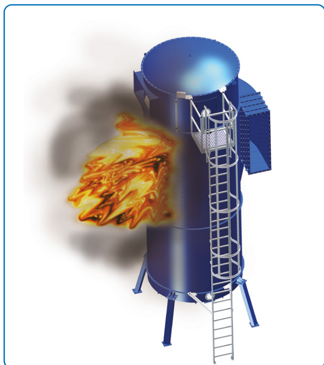
1. Eksplosionsafkastning i filterkroppen
